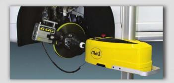
Проточка тормозных дисков с помощью установки фирмы MAD DA2002 показала себя, как эффективный, постоянно используемый в течении многих лет метод для ремонта и обслуживания тормозных В гарантийных случаях, при предпродажной подготовке подержанных автомобилей и при плановом обслуживании этот способ обработки тормозных дисков выявил ряд преимуществ по сравнению с заменой дисков на новые.
