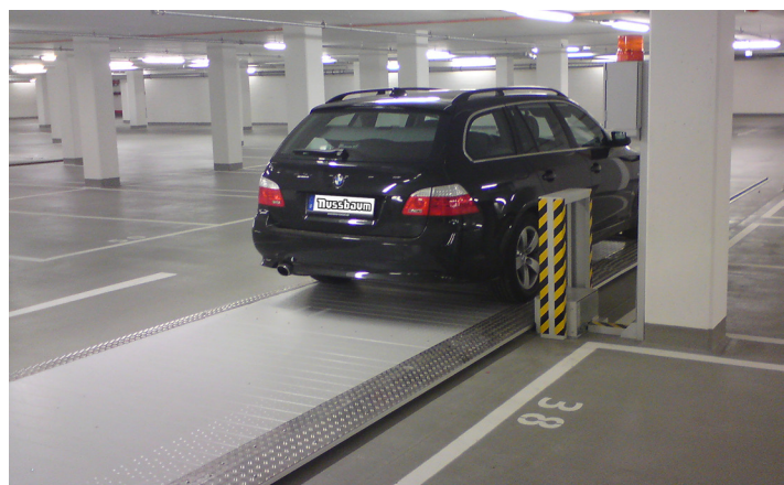
Парковочная платформа N6201 – двойная платформа для 2 машин одна за другой
