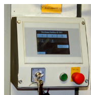
Стандартный блок управления (без ворот): сенсорный экран с блокировкой ключом и кнопкой аварийного останова
