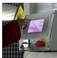
Стандартный блок управления: сенсорный экран с ключом и кнопкой аварийного останова в полуавтоматическом режиме
