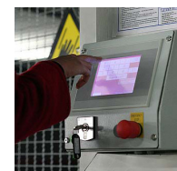
Опциональный блок управления (с воротами): сенсорный экран с ключом и кнопкой аварийного останова в полуавтоматическом режиме
