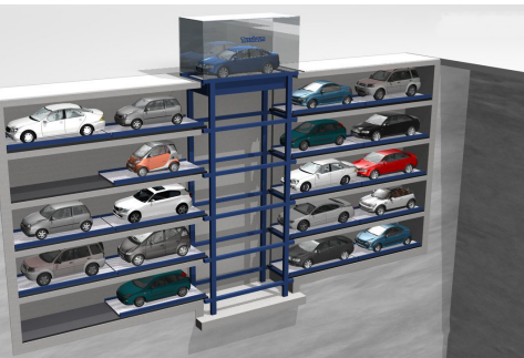
Borderparker N8100 (продольное размещение)
