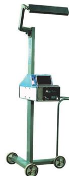
**HLT 650** – мобильное электронное устройство для диагностики фар автомобилей, предназначенное для проверки и регулировки фар с: лампами накаливания, галогенными и ксеноновыми лампами; оснащено цифровым люксметром. Система датчиков автоматически определяет и оценивает распределение пучка света от фары. Оснащен линзой Френеля и поворотным зеркалом. Измерительная камера оснащена удобной ручкой со стопором для перемещения и надежной фиксации камеры на нужной высоте.
