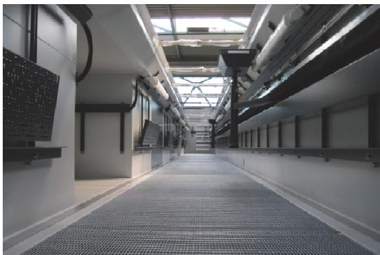
SMT **truckbay** – полностью оснащенная, смонтированная в заводских условиях яма для осмотра и диагностики автомобилей. В комплекте с диагностическим оборудованием, таким как тормозной стенд, тестер люфтов подвески, ямный осеподъемник. Все оборудование поставляется от одного производителя
