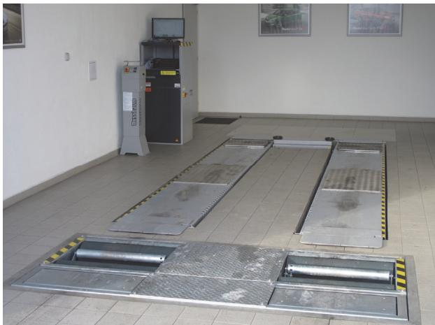
Наиболее распространенный способ монтажа легковых тормозных стендов – моноблочная секция вровень с полом.
