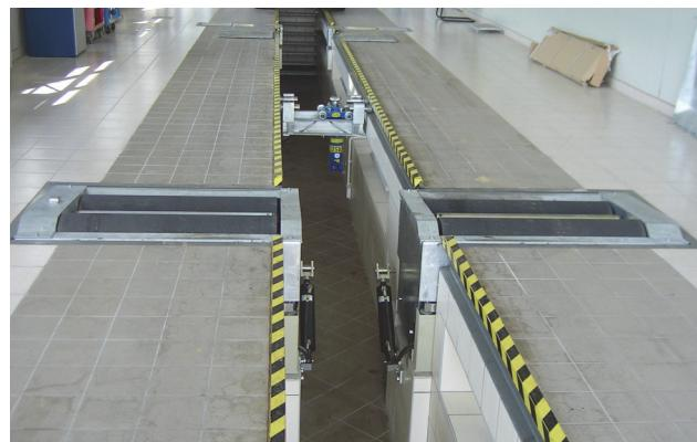
Высота легковой роликовой секции 26 см позволяет устанавливать тормозной стенд на пол с возвышением эстакады. Для корректности измерений, а также удобства заезда и съезда длина эстакады как до, так и после стенда должна быть не меньше колесной базы автомобиля.
